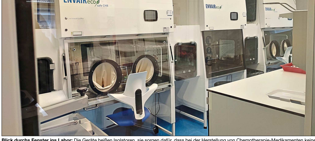
Blick durchs Fenster ins Labor: Die Geräte heißen Isolatoren, sie sorgen dafür, dass bei der Herstellung von Chemotherapie-Medikamenten keine Viren, Bakterien oder Staubpartikel in die Infusionen gelangen.
